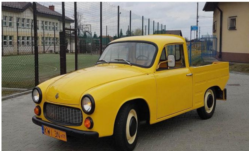
Der Siren R20 hat eine Ladekapazität von bis zu 350 kg Ladung. Höchstgeschwindigkeit ca. 80 km/h. Das Fahrzeug wurde von 1972 bis Mitte der 1980er Jahre produziert (Foto Internet)
